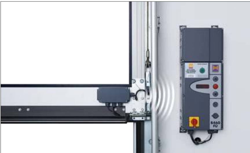
Funk-Übertragungseinheit zur Übertragung der Signale vom Torblatt via Bluetooth zur Steuerung (keine Wendelleitung), Stromversorgung über eine leistungsstarke Batterie; anschließbare Komponenten: Optosensoren LE (low energy), voreilende Lichtschranke VL1-LE / VL2-LE, 8k2-Leiste, Schlaffseilschalter, Schlupftürkontakt, Nachriegelkontakt
